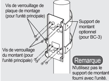
Fixez la plaque de montage du corps de la base d'unité et le support de montant pour l'option fournie avec le couvercle arrière en utilisant les vis fournies.
