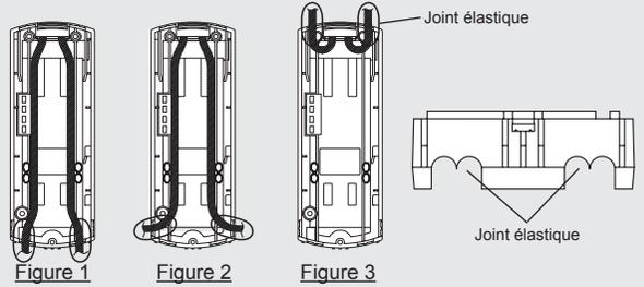
Le guide de câblage doit être disposé comme indiqué ci-dessous.
