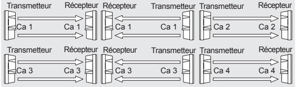
**Remarque** Il n'est pas possible d'utiliser plus de deux applications à faisceaux superposés.
