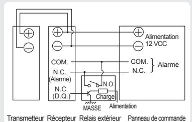
En utilisant le relais extérieur (N.O.), la sortie d'alarme peut être annulée pendant que le D.Q. envoie le signal.
