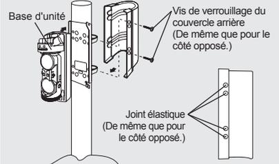
Après avoir monté les bases d'unités, alignez les axes optiques et vérifiez le fonctionnement, puis refermez le couvercle. (Reportez-vous à la section "3. INSTALLATION".)
