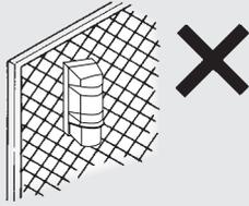
2. N'installez pas l'appareil à un endroit où des objets tels que des plantes ou du linge sont animés par le vent, car le faisceau pourrait être bloqué.
