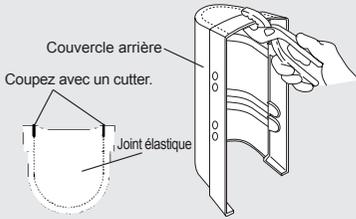
Sectionnez la partie du joint élastique du couvercle arrière avec un outil tel qu'un cutter.
