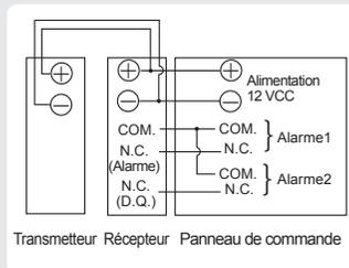
Utilisez la borne COM pour la sortie d'alarme et le circuit D.Q.
