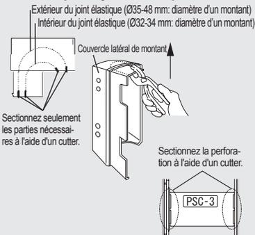
Sectionnez le bord du joint élastique (intérieur ou extérieur) à l'aide d'une pince puis rompez la partie du joint élastique à l'aide d'un cutter. Rompez aussi le pont central du couvercle latéral de montant en même temps que la perforation.
