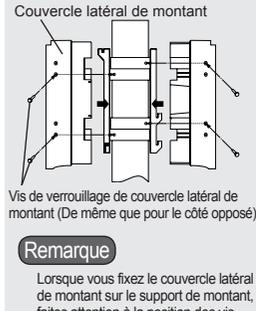
Fixez le couvercle latéral de montant sur le support de montant à l'aide des vis (8 vis).
