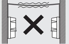
6. N'installez pas l'appareil sur des surfaces instables.
