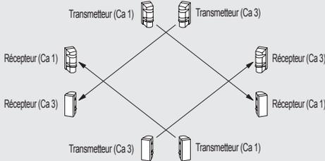
**4. Protection pour long périmètre avec deux appareils superposés**
