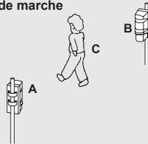
Veillez à effectuer un test de marche (pour bloquer le faisceau infrarouge) aux trois points suivants:
