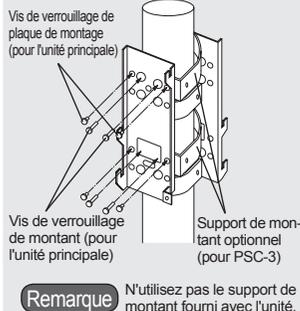
Fixez la plaque de montage du corps de la base d'unité et le support de montant pour l'option fournie avec le couvercle latéral de montant en utilisant les vis fournies.
