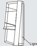
Mettez le couvercle en place et serrez la vis de verrouillage du couvercle. Assurez-vous que le bord du couvercle atteint bien la ligne préparée sur le côté de la base d'unité. (Reportez-vous à l'illustration ci-contre à gauche.)
